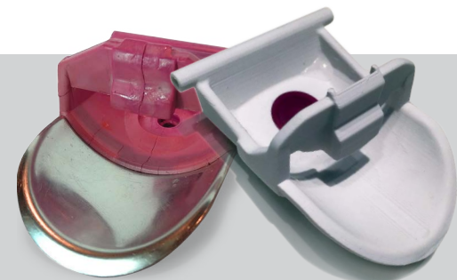
Links: Das ursprüngliche, gebrochene Einzelteil. Rechts: Die Neuentwicklung, gedruckt aus ABS
