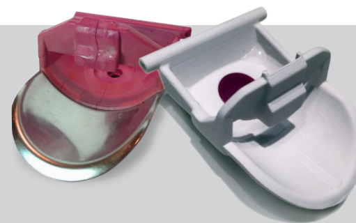
Links: Het originele, gebroken onderdeel. Rechts: Het herontwerp, geprint in ABS
