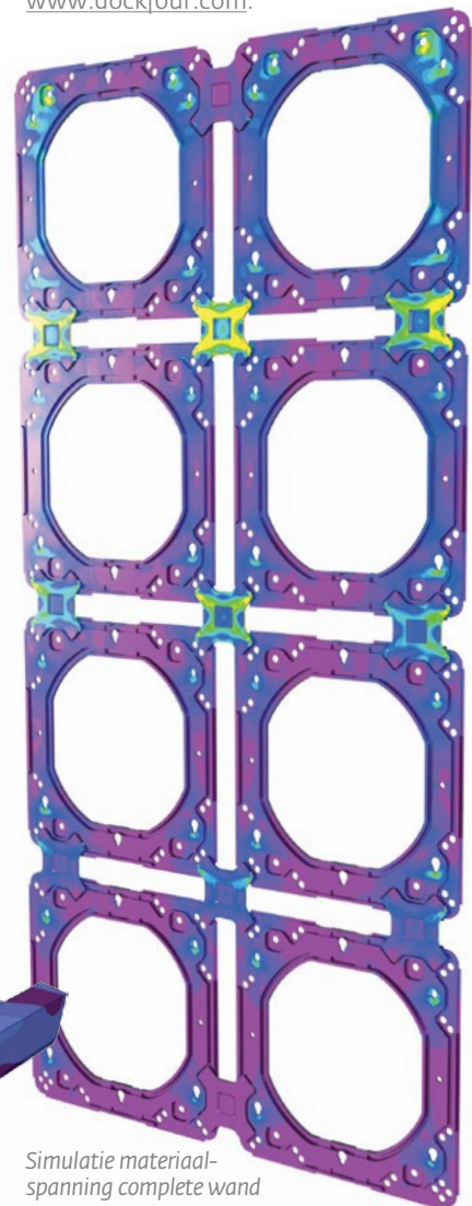
Simulatie materiaalspanning klikverbinding koppelstuk
