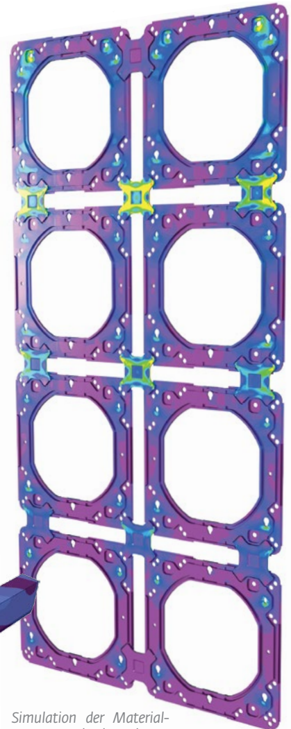
Simulation der Materialspannung im Klickmechanismus des Verbindungsstücks
