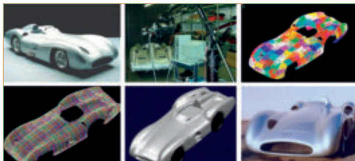
Reverse engineering: van product via 3D scan naar CAD
