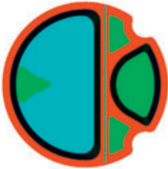
Met de oorspronkelijke wanddikteverdeling zou het product onevenwichtig vullen.
