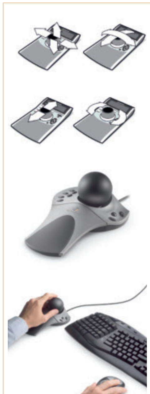
Bij het werken met een spaceball volgt het beeld alle bewegingen die de gebruiker op de bal uitoefent. Er kan met twee handen gewerkt worden.
